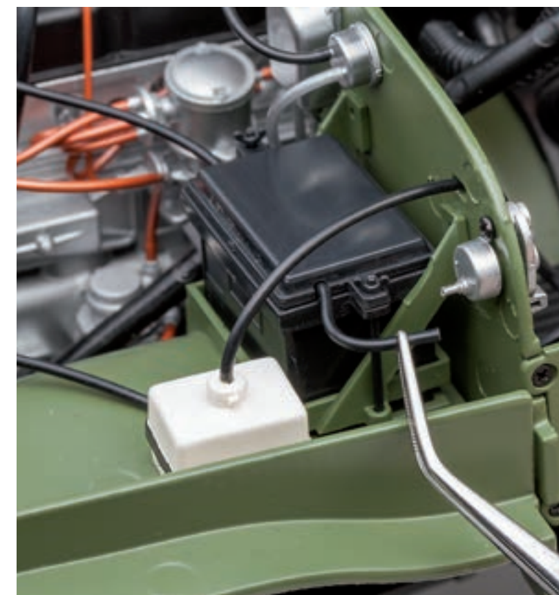
Шаг 12. Свободный конец массового провода закрепите на крепежном штыре выключателя массы.
