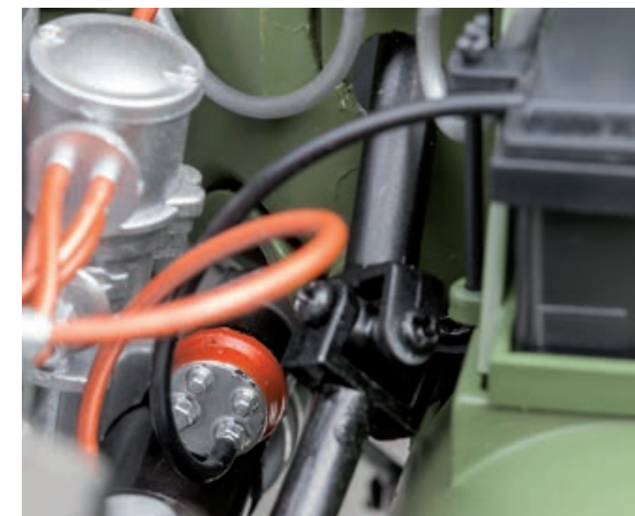
Шаг 13. Свободный конец провода к стартеру закрепите на крепежном штыре корпуса втягивающего реле стартера. При необходимости укоротите провод.
