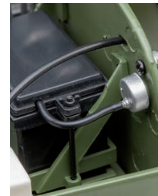
Шаг 12. Свободный конец массового провода закрепите на крепежном штыре выключателя массы.
